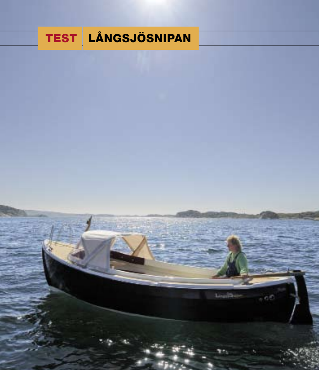
TEAKDÄCK INGÅR i standardutrustningen. Nannidieseln på 14 hästar ger en marschfart på fem knop.
